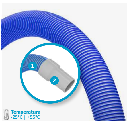
1. Tubería realizada en base a copolímeros de etileno, corrugada y de perfil redondeado para mayor flotabilidad durante el servicio de trabajo. 2. Manguito giratorio 360° que evita nudos y aporta mayor libertad de movimientos.
